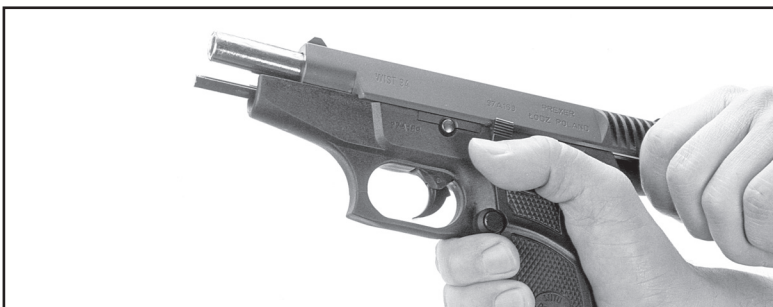
Fot. 14 Odciągnięcie zamka w tylne położenie
