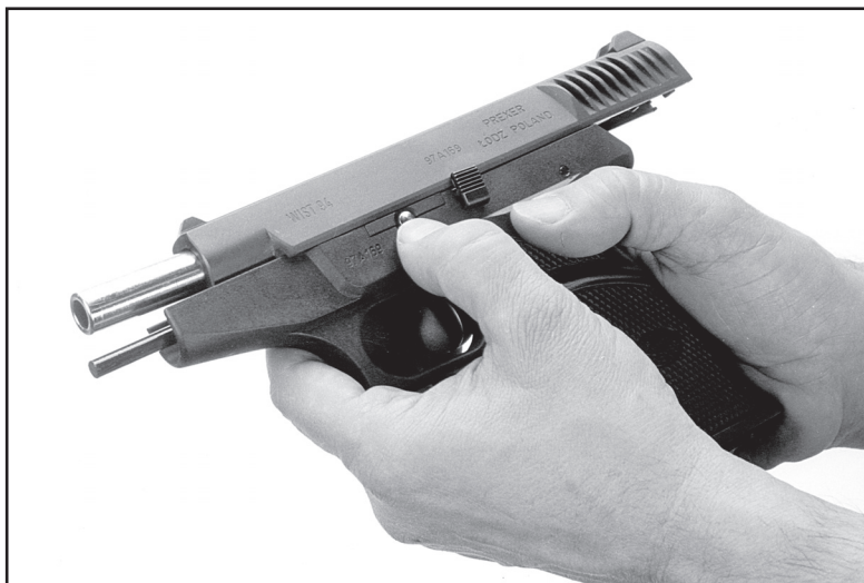
Fot. 15 Wcisnięcie osi głównej
