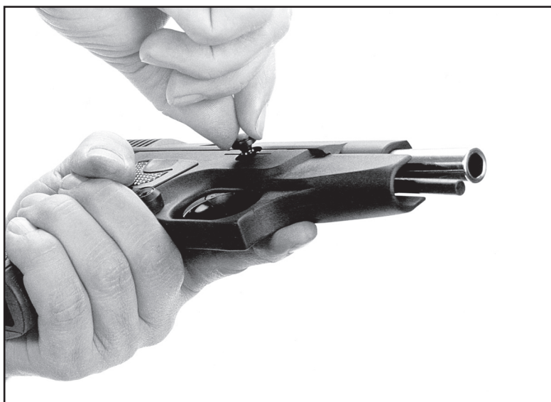
Fot. 16 Wyciąganie osi głównej
