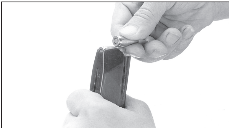
Fot. 12 Ładowanie magazynka
