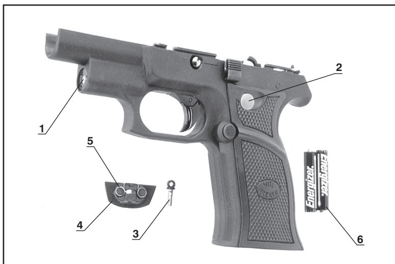
Fot. 6 Zmontowany szkielet pistoletu WIST 94L: 1 - moduł laserowy; 2 - włącznik celownika laserowego; 3 - ucho; 4 - zaślepka z nakrętką M3,5; 5 - sprężyna; 6 - baterie zasilające
