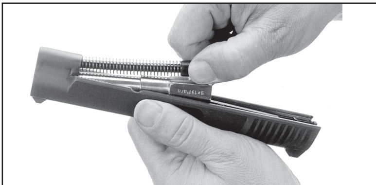
Fot. 18 Odłączenie zespołu sprężyny powrotnej od zamka
